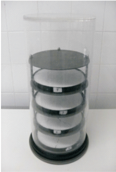
Figura 4 - Material já gomificado no equipamento utilizado para secagem do amido: Liofilizador Modelo LB 1500
